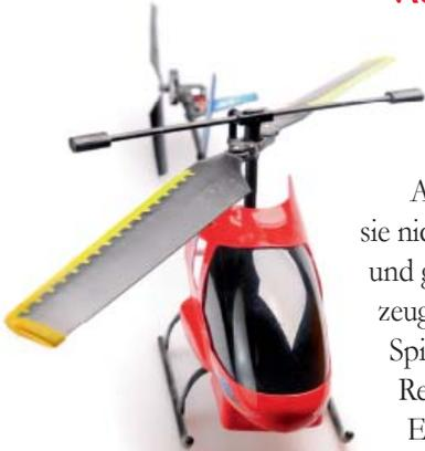
Aus den Spielzeuggeschäften sind sie nicht mehr wegzudenken. Kleine und größere ferngesteuerte Spielzeughubschrauber. Diese kleinen Spielzeughubschrauber sind in der Regel sehr leicht, werden von einem Elektromotor mittels Akkus angetrieben und funktionieren über einen Koaxialrotor (zwei gegenläufige Rotoren übereinander).
